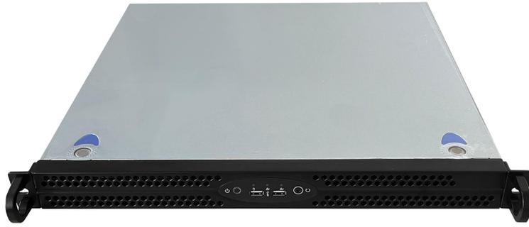
**4G EPC 服务器：**核心网电信级软硬件设备，由四个网元构成：移动性管理设备（MME）、服务网关（S-GW）、PDN 网关（PGW）、和归属用户服务器（HSS），实现手机接入和数据业务信令转换和基站切换。最大支持：128 个基站；接入注册用户数：1500 个；语音并发：800 个；数据业务并发 800 个；数据交换能力：大于 2Gbps。
